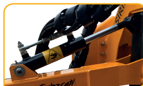
Martinetto alzato braccio Vertical lift arm jack
