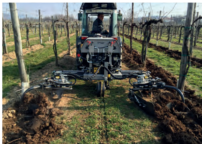
VEGA MAXI con aratrini - VEGA MAXI with ploughs
