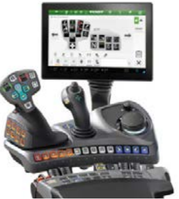
Power+ Setting 2 - Joystick 3L - 2 moduli lineari per controllare le valvole idrauliche
