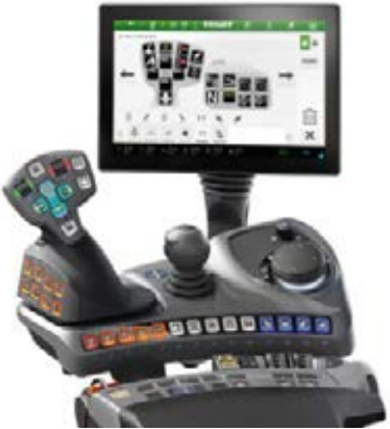
Power Setting 2 - Leva a croce - Moduli lineari per controllare le valvole idrauliche assenti
