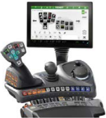
Profi Setting 1/ Profi+ Setting 1 - Leva a croce - 4 moduli lineari per controllare le valvole idrauliche
