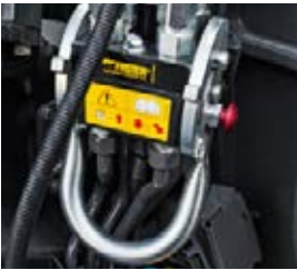
Giunto multiplo standard per montaggio e smontaggio rapidi
