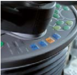
Tasti a membrana per blocco dell'attrezzo e attivazione dell'ammortizzazione.
