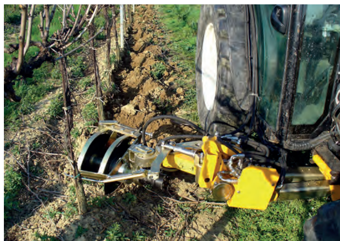
MITO con Dischiera scolmatrice - MITO with motorized disc plough
