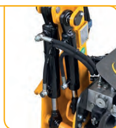
Sistema di autolivellamento Self-levelling system
