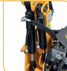
Sistema di autolivellamento Self-levelling system
